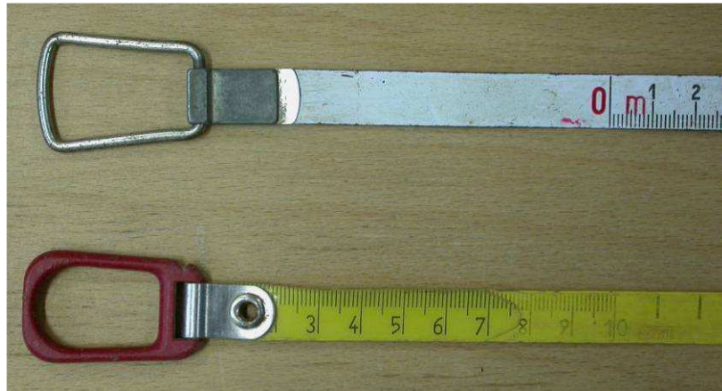
Abb. 1. Metallband mit Beginn der Meßskala auf dem Band, unten: Kunststoffband mit Ansatz der Meßskala am Bandende.
